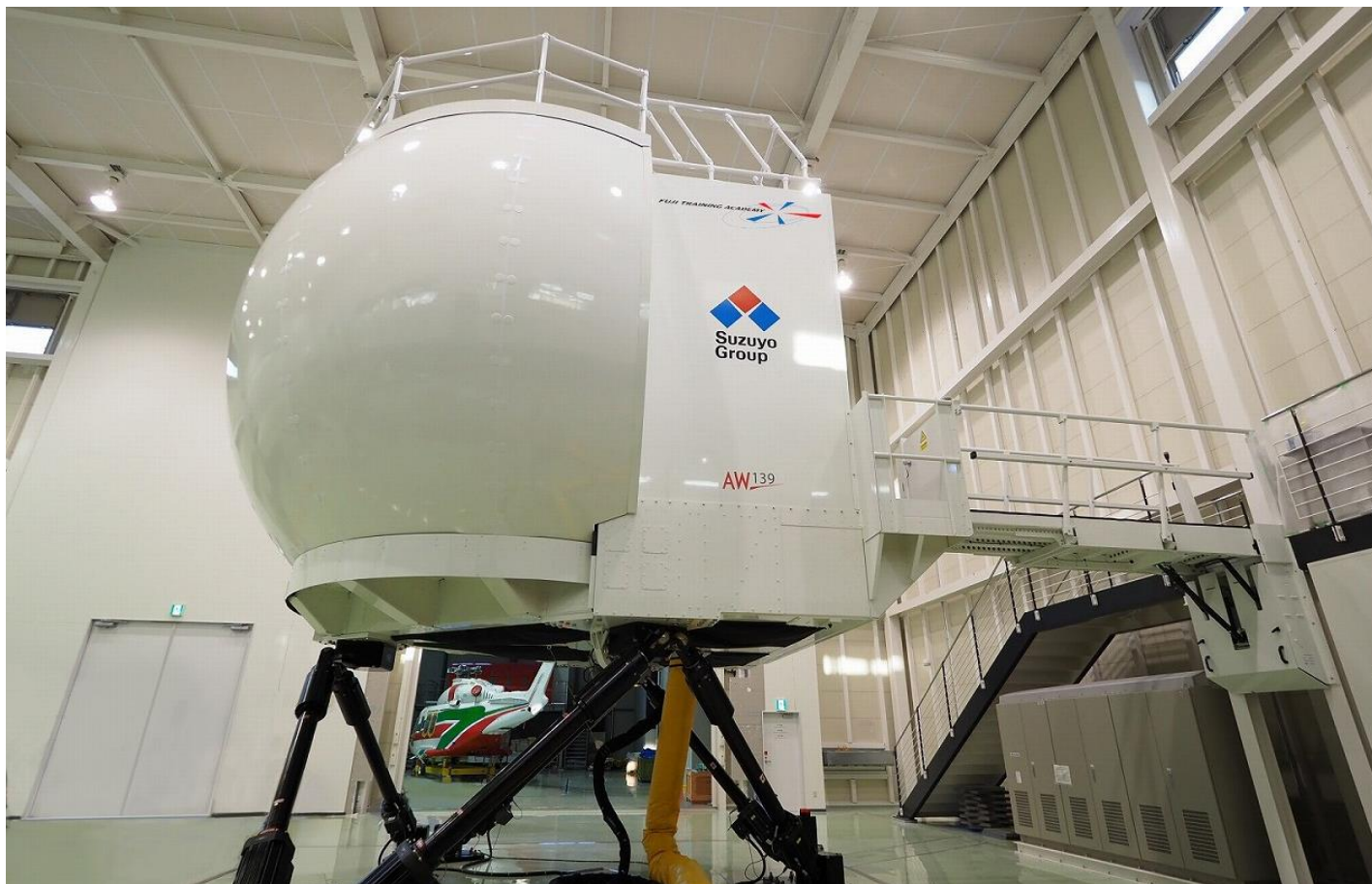
【認定を受けた航空機の型式】レオナルド式AW139型フル・フライト・シミュレータ (FFS) Level-D
